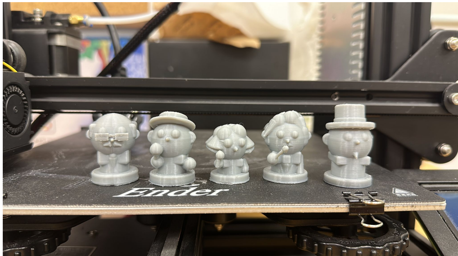
Spēles figūriņas drukāšanas procesa starpposmā.
