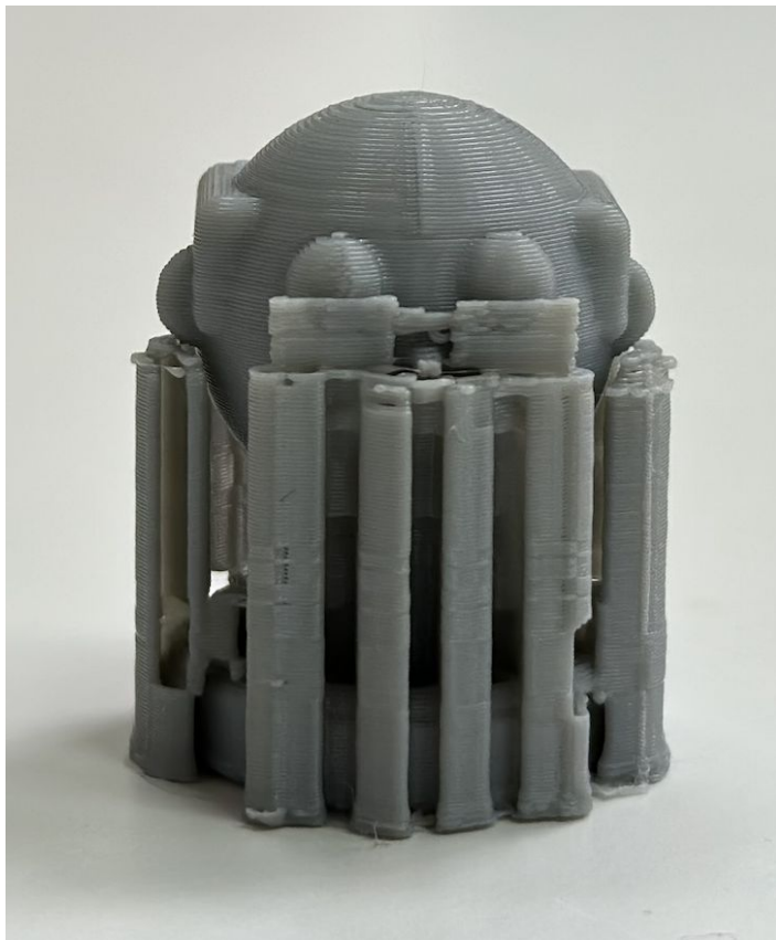
Izdrukātais objekts pirms suportu noņemšanas.
